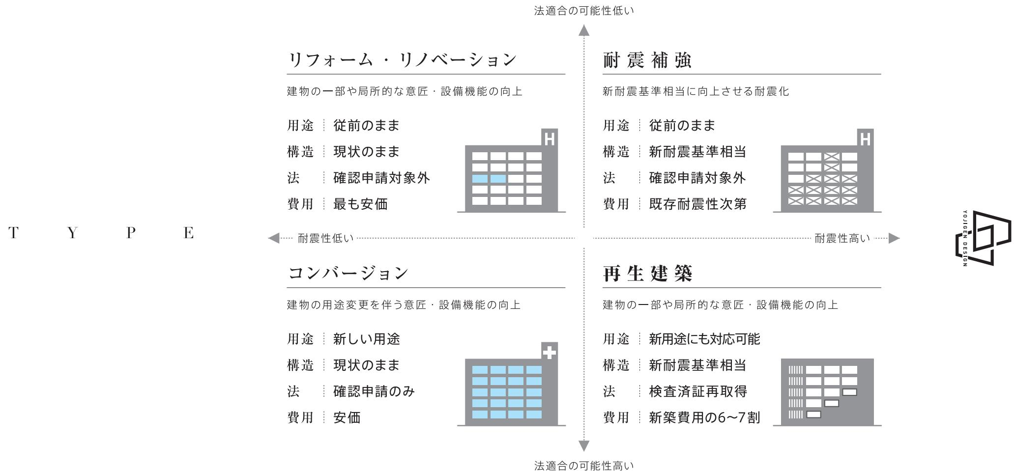
広い意味では、リフォームやリノベーションも再生建築に含まれますが、建物一棟で考えた時に、構造的、法的、長期的な視点が抜け落ちていることがしばしば見受けられます。四次元設計では、既存建物の耐震化、適法化、長寿命化を実施し、長く安全で安心な建物に生まれ変わらせます。
